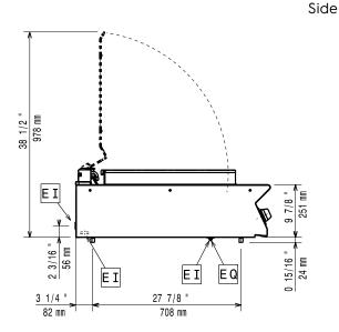
Drain ΕI Electrical inlet (power) EQ Equipotential screw Water inlet
